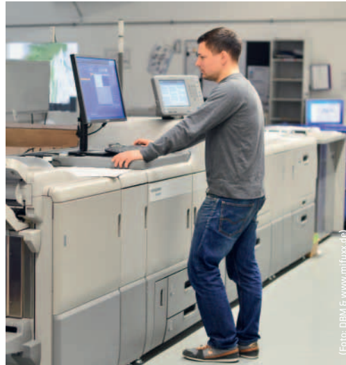
Auf der neuen Digitaldruckmaschine des Typs Heidelberg Linoprint/Versafire CV werden auch Druckerzeugnisse mit dem Blauen Engel produziert.
